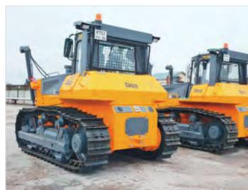
долго. Завод-изготовитель выпускал бульдозеры в комплектации с рыхлительным оборудованием, при этом центр тяжести находился в геометрическом центре машины. В Сургутнефтегаз транспортное средство поступило согласно технической спецификации, без задней навески, и центр тяжести сместился вперёд. Тем не менее, смекалистые
